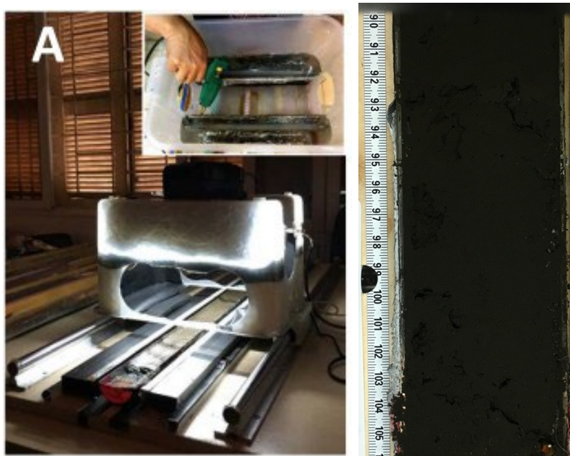
Hình 2.5. (A) Hộp chụp ảnh lõi trầm tích tránh ánh sáng chói phản xạ từ bề mặt mẫu ướt với ánh sáng phân cực. (B) Một phần cột mẫu đã được chụp ảnh
