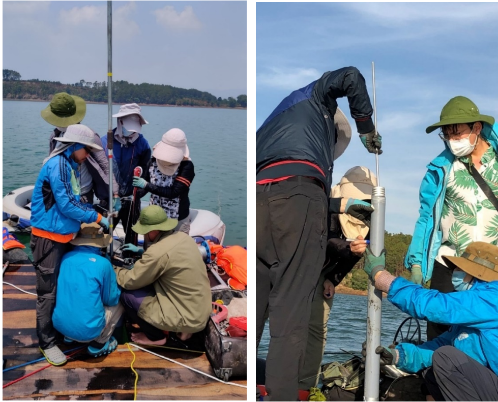
Hình 2.4. Lấy mẫu trầm tích bằng thiết bị piston tại Biển Hồ.
